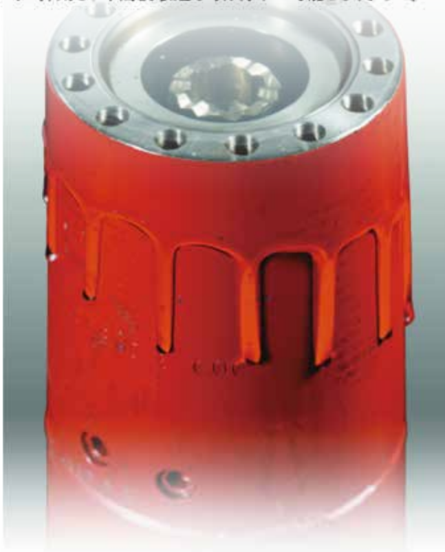
コンペンセーティング・SHIPPING・キャップ を取り外したもーター上部
