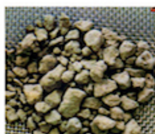
泥岩層スライム
